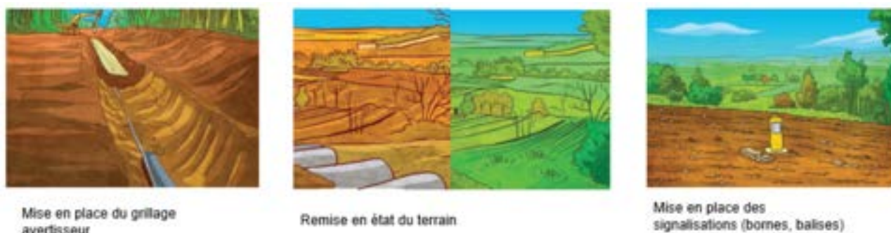
Figure 5. Présentation des travaux de pose d'un gazoduc en tracé courant (source : TEREGA)
